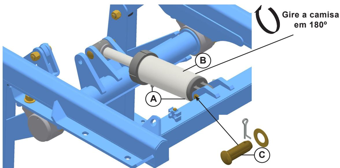
Em seguida, faça a movimentação de 180°, deixando os terminais (A) virados para cima e permanecendo a haste do cilindro voltada para a direção do rodado (D) da grade, como ilustra a figura.
