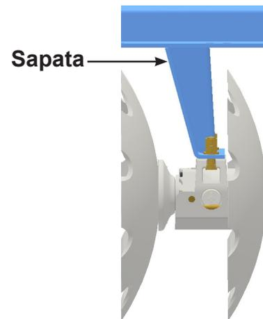
Coloque o parafuso (A), passando pela caixa do mancal (E) e pelo orifício da sapata (D); por cima coloque arruela lisa (B), porca e contraporca (C).
